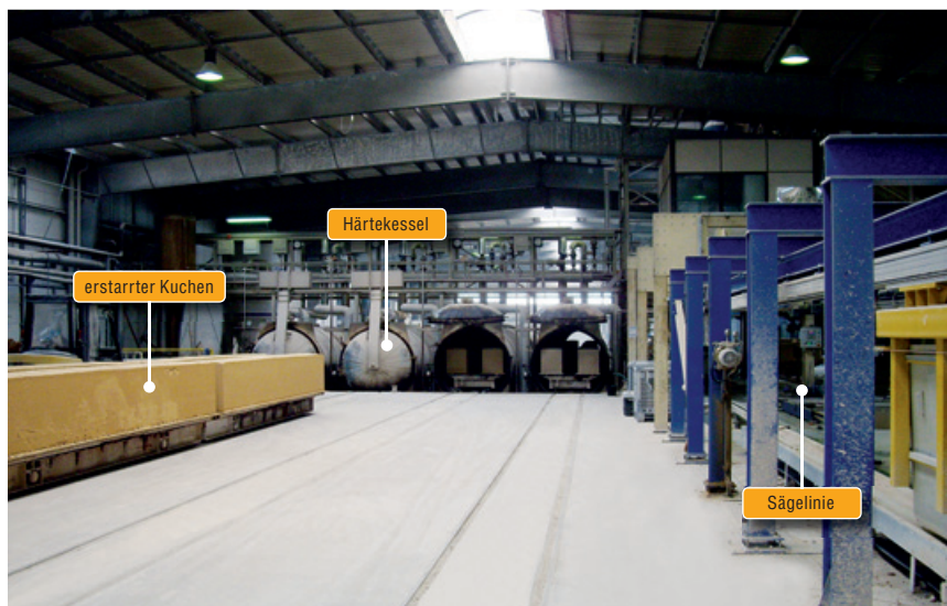
Im Porensteinwerk: Der erstarrte Kuchen (links) geht nach der Sägelinie (rechts) in die Härtekessel
